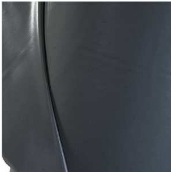
Bild: Eine PE-Folie dient als Feuchtigkeitssperre.
